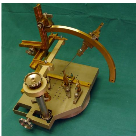
Рис.6 Наведение инструмента наводящим устройством на модель точки-мишени (а), перенос наводящего устройства на голову и наведение инструмента на мишень (б)
